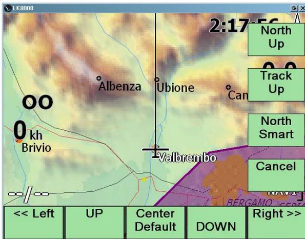
In diesem Menue kannst Du schnell zwischen Nordorientierung der Karte (**North up**) und Orientierung in Flugrichtung (**Track up**) umschalten, letztere mit Nordorientierung während des Kreisens.
