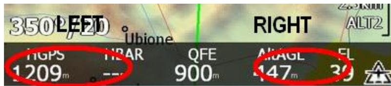
Durch Klick auf den rechten Bereich der Fußzeile wird der nächste Wertestreifen dargestellt, durch Klick auf den linken der vorherige. Gelangt man wieder zum ersten Streifen, ertönt ein hoher Klick-Klang, ansonsten ist der Streifenwechsel mit einem Ton verbunden.
