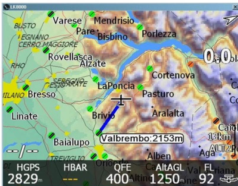
Das hohe Entwerr-Niveau berücksichtigt Deine Höhe, Deine Gleitzahl, die Anzahl der Flugplätze um Dich herum und die Ankunftshöhe um zu entscheiden, was dargestellt wird. Wenn Du sehr hoch bist, wie in der Abbildung, wird LK fast gar keine Werte darstellen. In diesem Beispiel wird nur der Heimatflugplatz als besonderer Platz an den Du zurückkommen willst, mit Werten gezeichnet.
