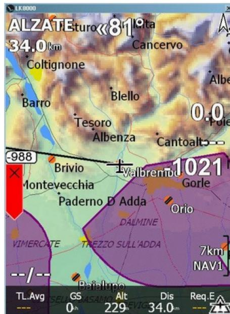
Im Hochformat steht der "IBOX"-Anzeigemodus noch zur Verfügung und kann durch klick aktiviert/deaktiviert werden. Man kann ihn bei Bedarf auch im Querformat benutzen.
