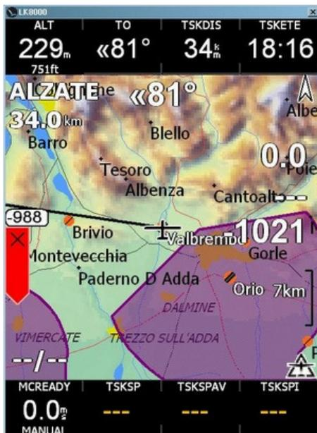
Der alte XCSoar Hochformat-Modus wird "IBOX"-Modus genannt. Die LK8000-Funktionen für das Wechseln der Seiten sind in diesem Modus nicht verfügbar. Durch einen einzelnen Klick kann man jedoch in den LK-Modus wechseln.
