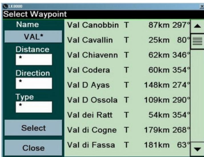
In der Name-Schaltfläche steht nun hier **VAL\*** und das bedeutet, dass alle Wegpunkte, deren Namen mit VAL beginnt, gelistet werden.
