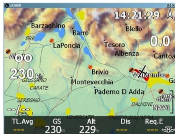
*Beispiel für die Neupositionierung des Flugzeugsymbols mittels **UP DOWN Left and Right** Schaltflächen*
