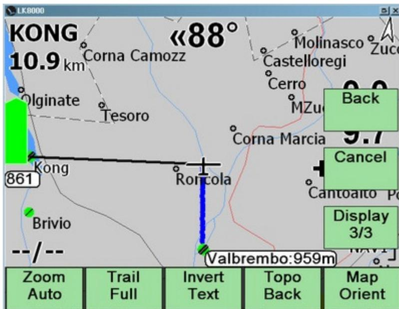
Aus dem Menue Display 3/3 kannst Du die Hintergrundfarbe sofort wechseln wenn Du auf die "Topo Back"-Schaltfläche klickst.
