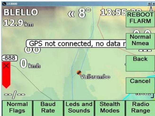
LK8000 besitzt eine eigene FLARM-Konfiguration, die im Menue unter CONFIG 3/3 erreichbar ist.
