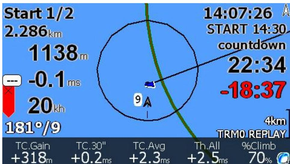
Der Wegpunktname wird z.B. in Start 1/2 geändert und zeigt an, dass für Dich Startzeitfenster 1 von zwei verfügbaren Zeitfenstern läuft.
