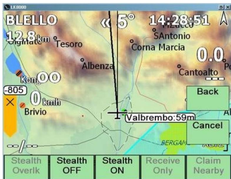
Seul Stealth ON et OFF sont disponibles dans ce menu. D'autres fonctionnalités sont réservées et/ou inhibées, car elles réclament maintenant pour le FLARM un firmware non officiel réalisé par des tiers.
