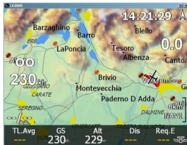
Exemples de repositionnements de l'aéronef en utilisant les touches UP DOWN Left and Right
