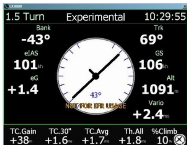
L'indicateur de virage "TRI" (Turn Rate Indicator) indique votre taux de virage, l'accélération estimée et la vitesse air estimée. **Tout est estimé**, si vous n'avez pas de vrai accéléromètre ni de réel capteur de vitesse air.
