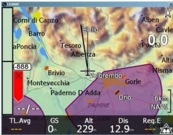
ici, ajout de l'indicateur de plan (pour l'arrivée ou le prochain TP) (Glide Bar Indicator): c'est la barre rouge sur la gauche .
