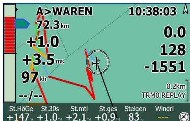
Abbildung 62: Balken-Variometer, Gleitfadbalken, Digital-Uhr
