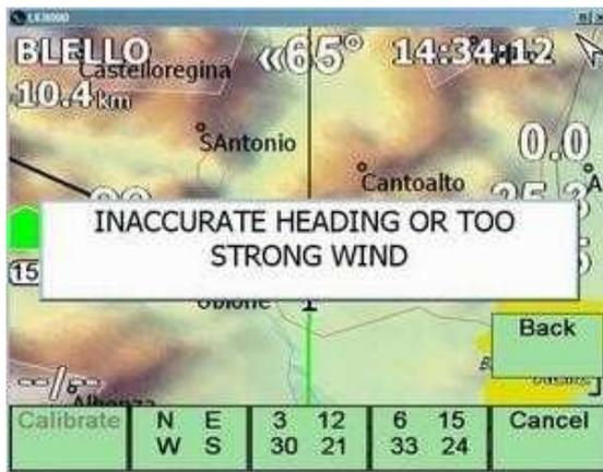
Abbildung 75: TrueWind-Fehlermeldung: zu starker Wind
