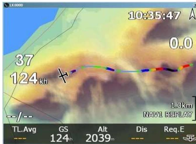
Abbildung 80: Schneckenpur mit farbigen Steigwerten
