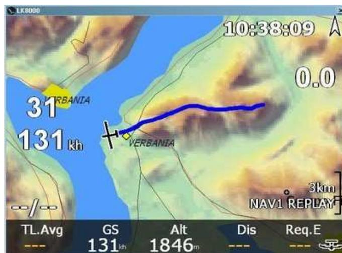
Abbildung 81: Schneckenpur bei geringem Zoom
