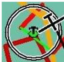
Dieser Kreis wird als der im Steigen abzufliegende Weg betrachtet und der Pilot wird falls nötig durch ein akustische Signal (1xGlöckchenklang) rechtzeitig zum kurzzeitigen, oder etwas längeren Aufrichten (2xGlöchenklang) aufgefordert um diesen Weg zu halten. Das Signal wird falls nötig immer wieder (rechtzeitig) an der entsprechenden Kreisstelle ausgegeben.
